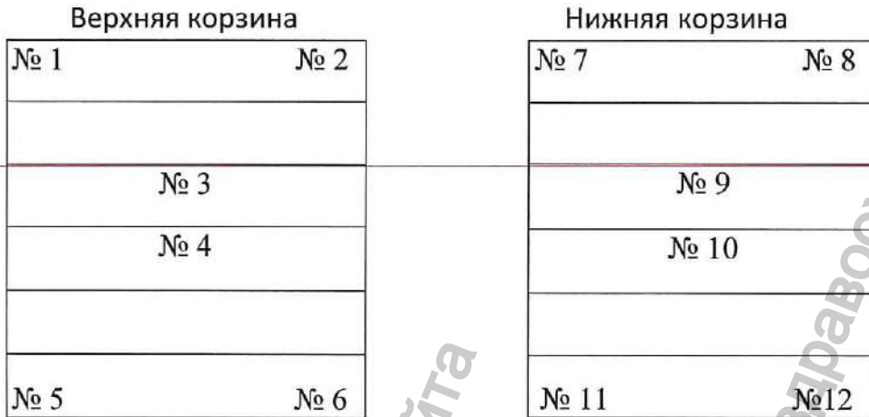
Рисунок 51 Схема расположения индикаторов для стерилизатора Пластер-120-01-«Мед ТеКо»
